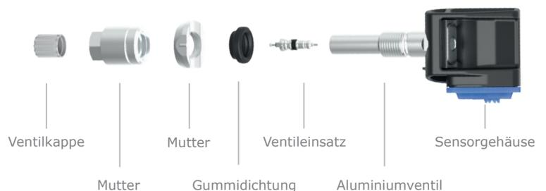
Kompressionskräfte, hohe Temperaturen und Korrosion können jede dieser Komponenten beschädigen. Werden diese Teile nicht ersetzt, kann es zu schleichenden Reifenundichtigkeiten kommen, wodurch die RDKS-Warnlampe häufiger aufleuchtet. Aus diesem Grund sollten wartungsfähige Teile jedes Mal ersetzt werden, wenn ein Reifen vom Rad entfernt wird.
